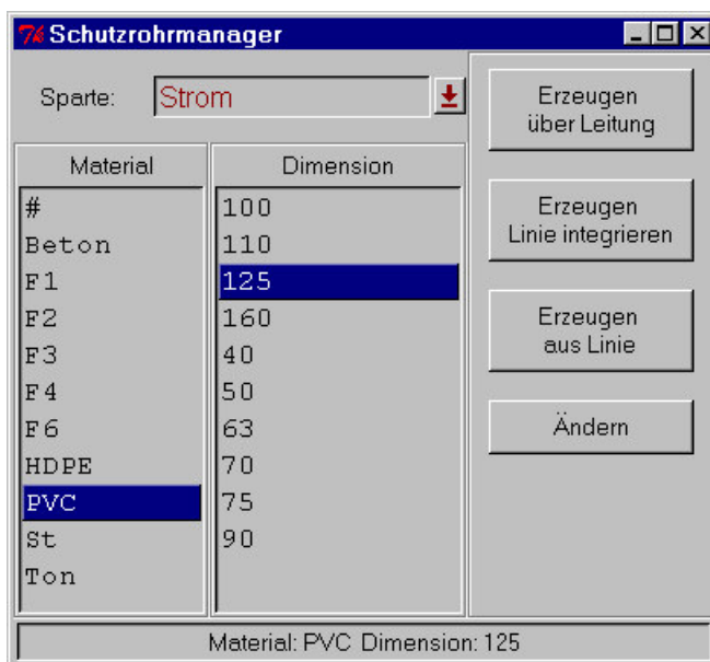
Abbildung 15 Schutzrohrmanager Auswahlmöglichkeiten von Material und der dazugehörigen Dimension
